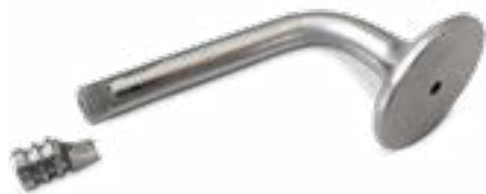
Rys. 1. Pęknięcie przeciążeniowe przy podcięciu
